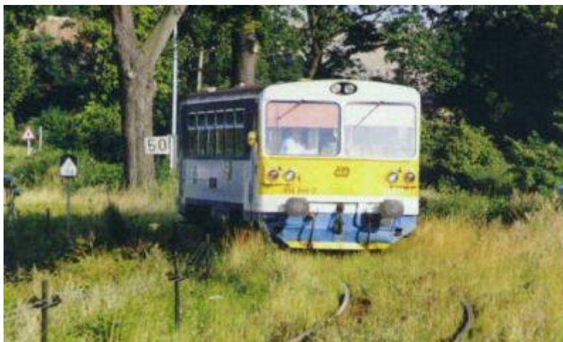
Obrázek 4 - Osobní přepravu zajišťují na většině regionálních drah v ČR motorové vozy řady 810 ze 70. a 80. let (foto repro Železniční magazín)
