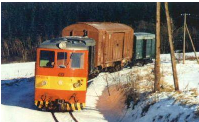
Obrázek 5 - Přeprava vozových zásilek na regionálních dráhách patří k nejméně rentabilním operacím v železniční nákladní dopravě - zde přeprava normálněrozchodného vozu na úzkorozchodných podvalnicích (foto J. Šatava, repro Dráha)
