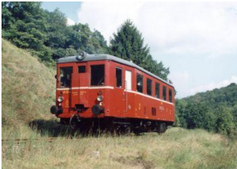
Obrázek 2 - Motorový vůz řady M 131.1 typický pro místní dráhy v 50. - 70. letech (foto R. Blecha)
