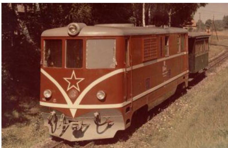
Obrázek 3 - Jedinými hnacími vozidly pro osobní i nákladní dopravu na úzkorozchodných tratích JHMD a ČD jsou nepřilíš hospodárné motorové lokomotivy řady 705 z 50. let, kdy proběhla poslední generační obměna parku hnacích vozidel na úzkém rozchodu (foto ČKD)
